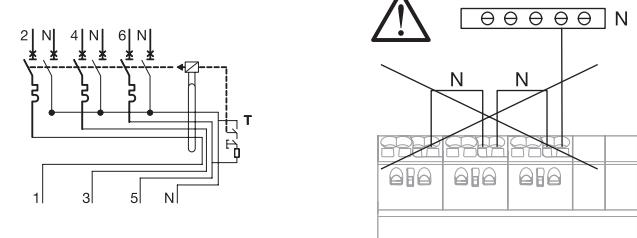
Ein Fehlerstrom-Leitungsschutzschalter für 3 einphasige (230V) Stromkreise. Der Schutzschalter ist nicht für 3 phasige Lasten geeignet.
